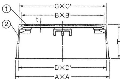
参考 下部内寸Dから約40<sup>ミ</sup>マイナスした寸法を有効 L寸法としています
