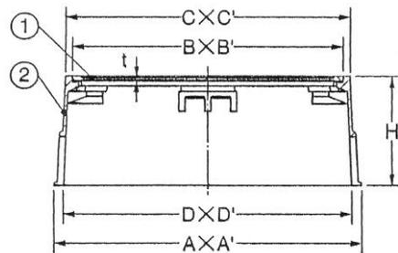
参考 下部内寸Dから約40<sup>ミリ</sup>マイナスした寸法を有効 L寸法としています
