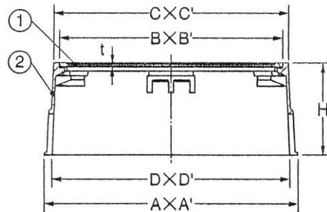
参考 下部内寸Dから約40<sup>±1</sup>マイナスした寸法を有効 L寸法としています
