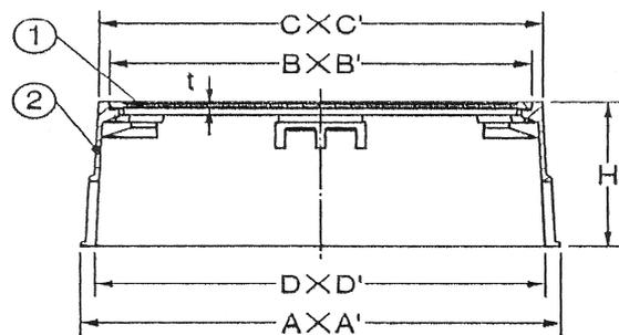
参考 下部内寸Dから約60<sup>±1</sup>マイナスした寸法を有効 L寸法としています
